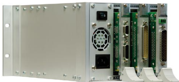
Bild 1: In der Standardversion bietet MSX-Box-CPCI vier Steckplätze für CompactPCI-Karten. Die Karten sitzen dank Führungsschiene und Auswurfhebel fest im Gehäuse und sind somit sehr unempfindlich gegenüber Vibrationen oder Schläge.
